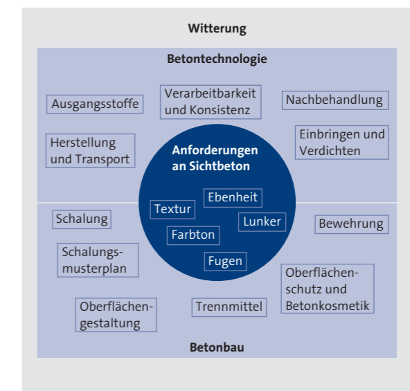
Fig. 1 Schéma des exigences applicables au béton de parement et facteurs relevant de la technologie du béton, de l'exécution et des conditions climatiques.
