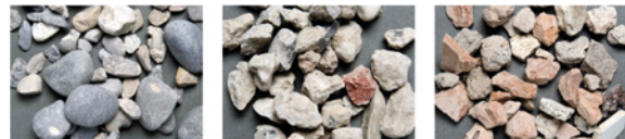
Figure 1: Granulats pour béton (à gauche: granulats naturels arrondis, au milieu: granulats de béton, à droite: granulats de gravats mixtes).
