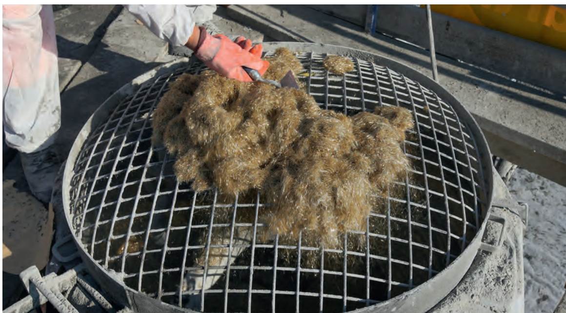
Le fort dosage en fibres d'acier augmente le comportement de déformation et rend Ductal® très ductile.
