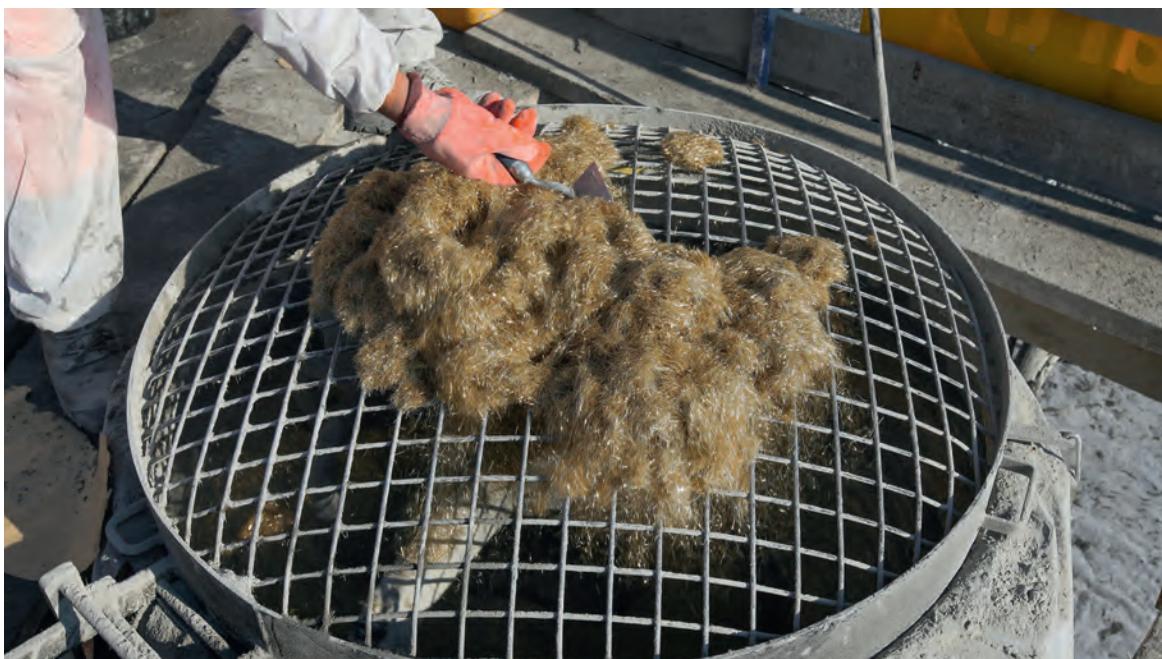
L'elevato contenuto di fibre di acciaio potenzia il comportamento di deformazione e rende Ductal® molto duttile.
