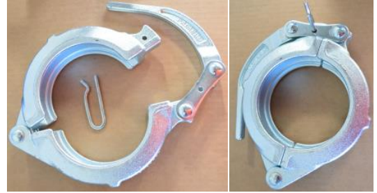
Schalenkupplungen mit Sicherungsstiften
